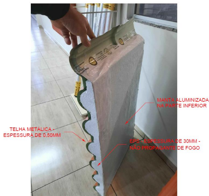
Imagem 2: Camadas da telha termoacústica
