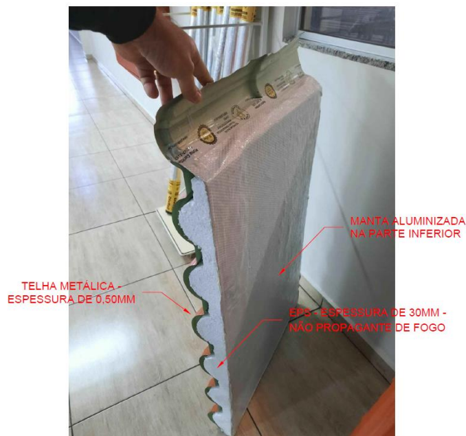
Imagem 2: Camadas da telha termoacústica
